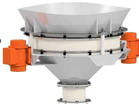
Die Unwuchtmotoren bewirken eine horizontale, gerichtete Bewegung der abgehängten Baugruppe und sorgt für einen zuverlässigen, verdichtungsfreien [Schüttgutfluss](#) nach dem „first in – first out“-Prinzip und eine gleichmäßige Befüllung nachgeschalteter Dosier- und Fördersysteme. Der entlüftende Effekt der Unwuchtbewegung verhindert zudem ein Durchschießen fluidisierender Schüttgüter und sorgt für eine Vergleichsmäßigung des Schüttgewichts.
