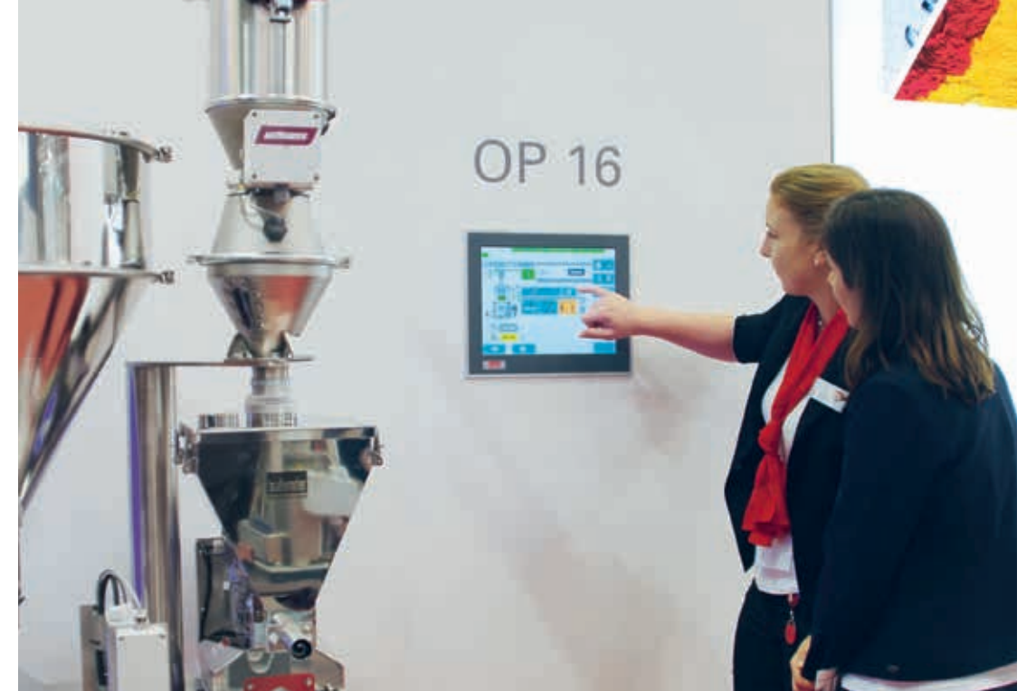
In der bewährten Oberfläche für die Bedieneinheit OP 16 ist das Element zur Steuerung des Nachfüllprozesses über einen Saugförderer bereits vorgesehen.
