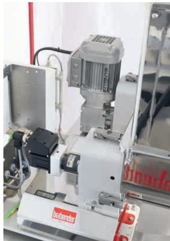
Der Drehstrommotor (hinten) und der neue Smart-Servo-Motor
