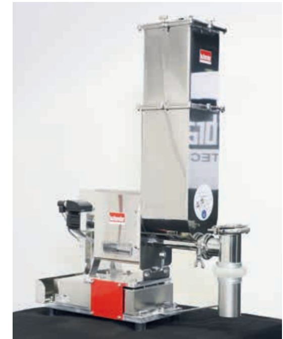
In der Batterie herstellenden Industrie kommt u. a. die explosionsgeschützte Ausführung des DDSR20 zum Einsatz.
