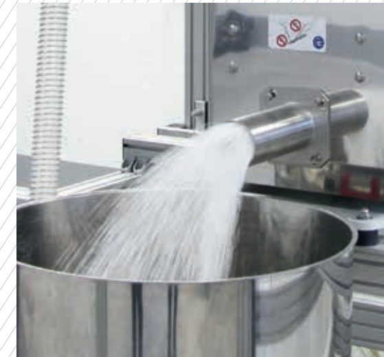
Abb. 4: Produktfluss mit Luftschub bei blockiertem Filter
