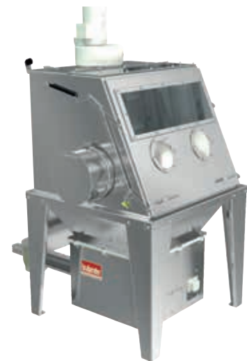
BagDumper: modulare Sackaufgabestation, optional mit integriertem Dosierer
