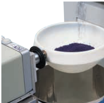
MicroBatch-Waage: addierende Kleinchar- genverwiegung nach dem „Gain-in-Weight“-Prinzip
