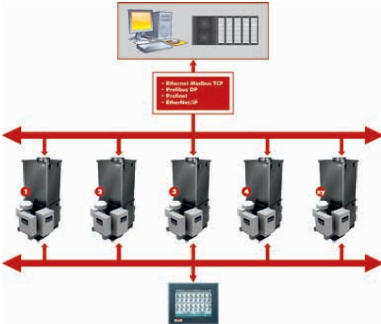
Mehrkomponenten-Steuerungslösung für gravimetrische Dosierer mit integrierten Steuerungsmodulen zum Direktanschluss an Host/SPS (wahlweise mit externen Modulen zur Schaltschrankmontage erhältlich)
