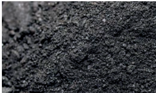
Ruß – brückenbildend, explosionsgefährlich
