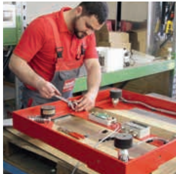
Umbau einer Wageplattform
