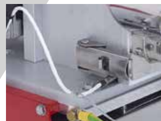
Temperaturfühler am Doppelwellengetriebe
