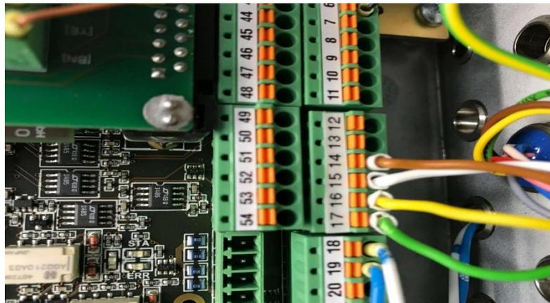
**3. Schritt** Verdrahtung am seriellen Konverter
